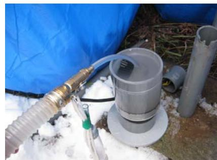
年代測定用の大気と遮断した地下水採取
