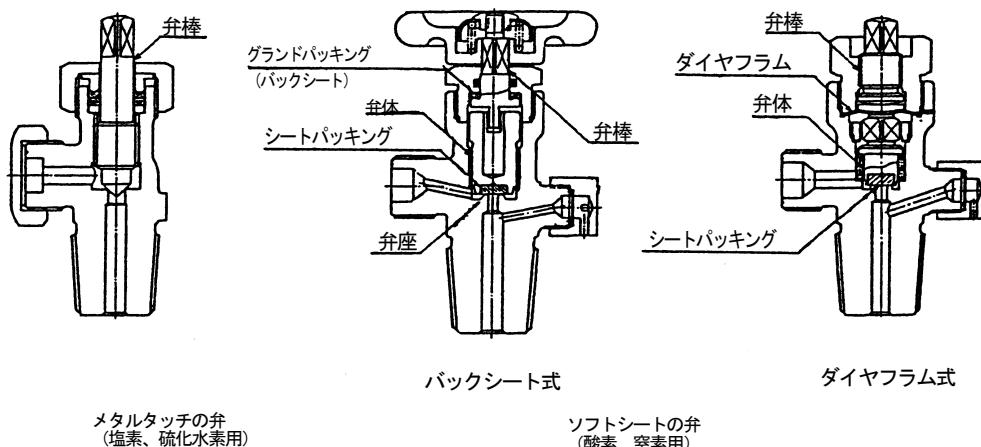
図II-6-1 高圧ガス容器弁
