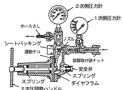
図II-6-2 圧力調整器
